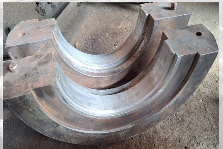
**Régulage et usinage coussinet palier moteur BK5 CIMENCAM à l'alliage anti friction**
